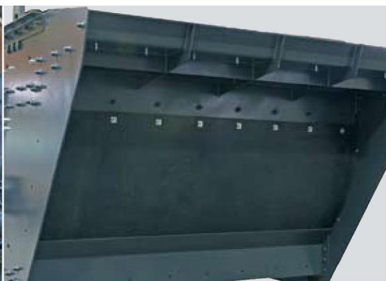
Система пылезащиты с загрузочной стороны
