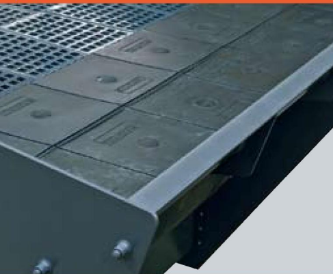
Загрузочный бункер с защитой от износа Sandvik
