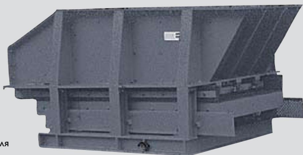
Питатель серии SH с возвратно-поступательным движением деки для первой стадии
